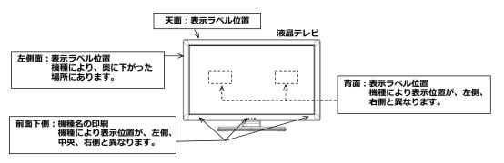
※機種により表示位置が異なります。上記位置のいずれかに印刷、または、ラベル表示しております。 図示の矢印に示す場所は、概略の表示位置を示します。実際は、異なる場合があります。
