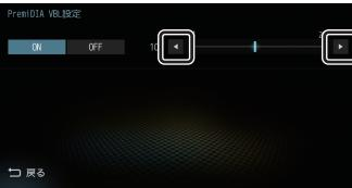
レベルを 20 方向へ補正するとより低音を抑えることができます。
