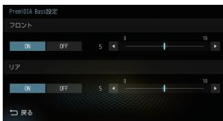
レベルを 10 方向へ補正すると低音の量感、厚みを増強できます。
