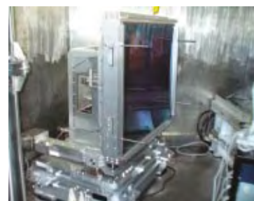
図3. 大型集光鏡 (1,200×1,200mm, 230kg, 5軸焦点調整機構付)
