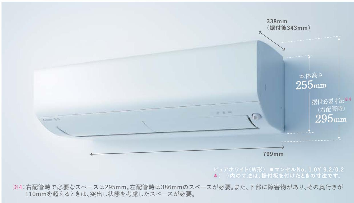
※4: 右配管時に必要なスペースは295mm。左配管時は386mmのスペースが必要。また、下部に障害物があり、その奥行きが110mmを超えるときは、突出し状態を考慮したスペースが必要。
