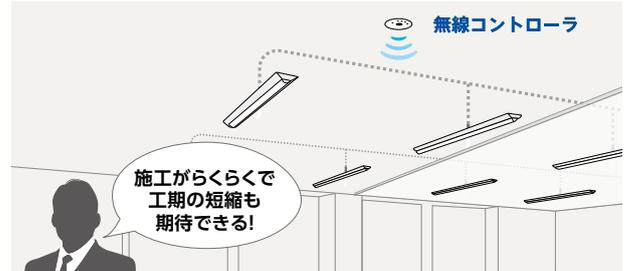
■ 固定出力のLED照明器具がらくらく手順でワイヤレス対応器具に
