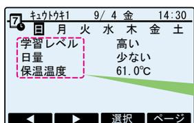
曜日ごとに日量(4段階)や保温温度を設定可能。ユニットの学習機能で貯湯量の目標値修正を行う機能も、リモコンから学習レベル(4段階)によって反映させるかを設定可能。
