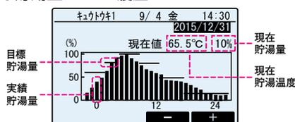
貯湯量トレンドグラフで1時間毎の目標貯湯量、実貯湯量をグラフ化。また4週間(28日)分のデータも保存しており、貯湯量推移の見える化を実現。
