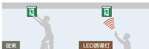
高所に設置された誘導灯は、点検時に脚立などが必要です。リモコン操作で自動点検をスタート。ラクラク点検が可能です。
