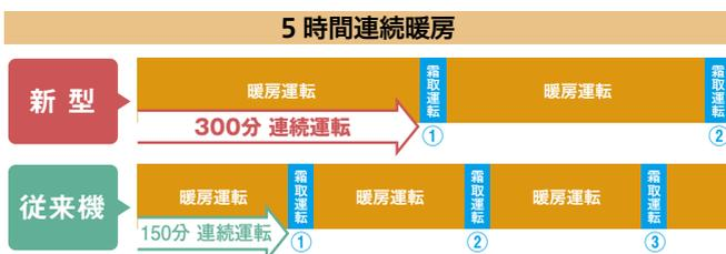
\*従来機PUZ-ZRMP-KA8/ZRP-KA13と新型機PUZ-ZRMP-KA11/KAとの比較。当社試験室(外気温-15°C)での最大運転時間。外気温度条件により、連続運転時間は異なります。
