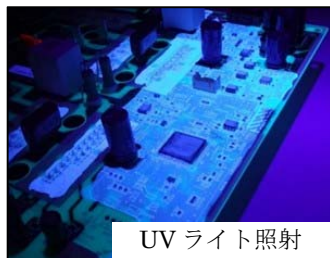
室外ユニット基板コーティング (右の写真の青白部がコーティング部分)
