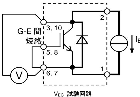
$V_{EC}$  試験回路
