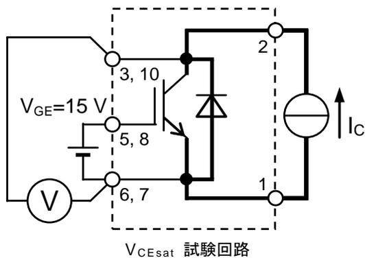
$V_{CEsat}$  試験回路
