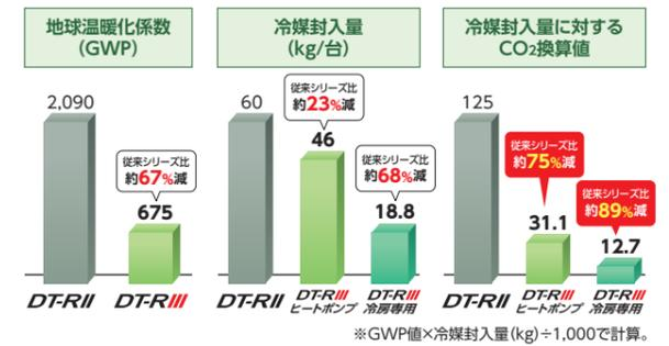
●R32冷媒の採用と、冷媒封入量の削減により、CO2換算値を大幅に削減!
