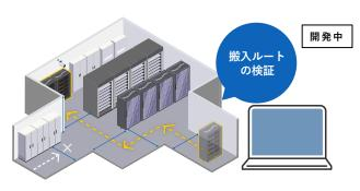
搬入機器の3Dモデルをインポート 搬入ルートをシミュレーション
