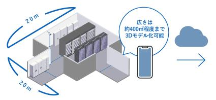
3Dモデルを生成し 通路幅や天井の高さを計測
