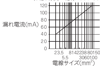
CVケーブルを金属管配線した場合の商用電源運転時の1kmあたりの漏れ電流例 (3相3線式△結線400V 60Hz)
