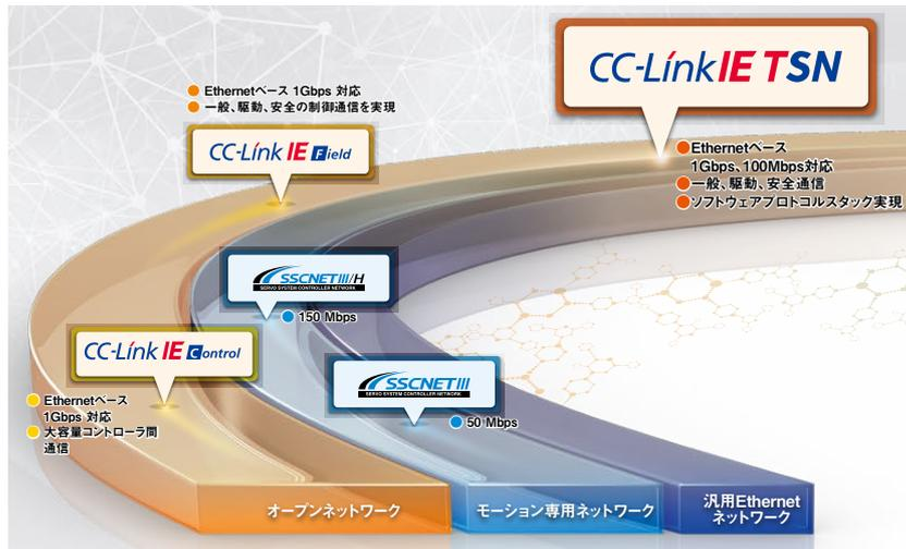
CC-Link IEフィールドネットワークの診断容易性、CC-Link IEコントローラネットワークの大容量通信、SSCNETの高性能モーション制御に代表される特長を継承し、刷新したプロトコルとTSN技術を採用した新たな産業用オープンネットワークCC-Link IE TSN。CC-Link IE TSNは、TSN技術を採用することで、よりオープンな産業用ネットワークとすると共に、効率的なプロトコルにより従来ネットワークが有する性能・機能をさらに強化しました。
