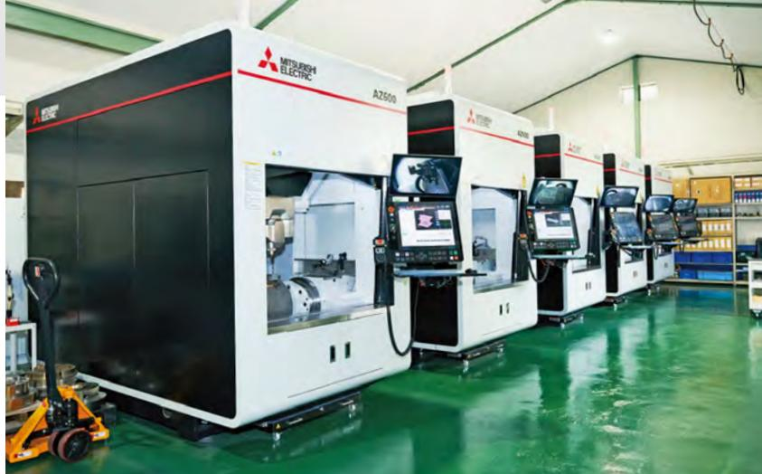
ラボ施設「MML」に設置された5台のAZ600。軸指令値、ワイヤ送給量、レーザ出力などが最適に協調制御できる。「24時間運転も可能」(下木氏)
