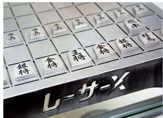
ステンレス鋼板にレーザー加工を施して製作した将棋盤と駒。技術力の高さが表われている。
