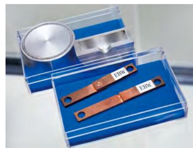
レーザー溶接は板厚が大きくても対応可能(上)、電子ビーム溶接は銅も精緻に溶接できる(下)。
