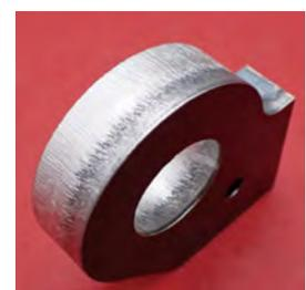
軟鋼厚板切断事例 (窒素切断)
