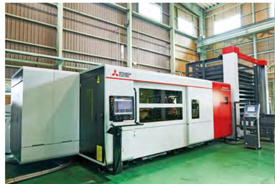
2024年1月に導入したパレットチェンジ・ストック付きの金属切断用レーザ加工機ML3015GX-F80。
