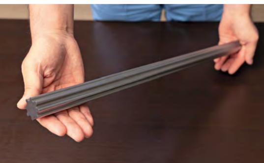
ワイヤ放電加工機による長さ600mmのサンプル加工品。金属ブロックから精密に切り出している。
