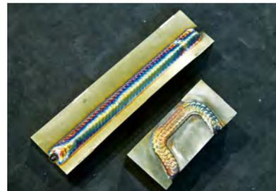
上はAZ600を用いた金属積層造形によるニアネットシェイプ工法の造形品。下はステンレス鋼の開先溶接のテスト品。
