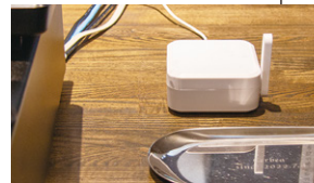
温湿度とCO 2 濃度を計測し、伝送する環境センサーはレジ脇に
