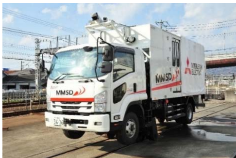
MMSDⅡを搭載した計測用車両 (線路走行時の状態)
