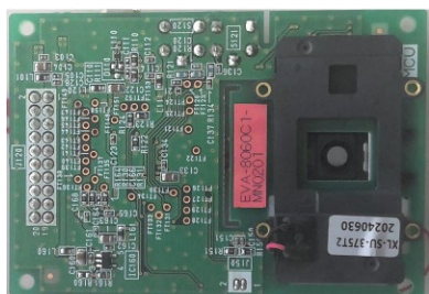
図3：評価用デモキット (78mm×54mm×13mm)
